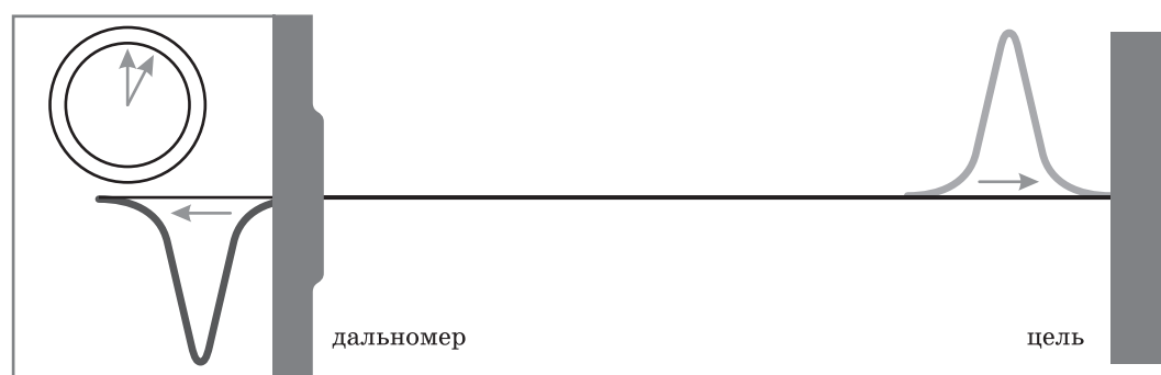
Рис. 2. Принцип работы импульсного дальномера
